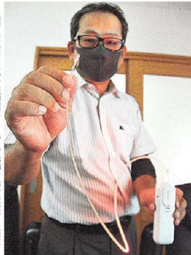
誤挿入を防ぐため、医療用チューブの先端を光で表示する装置 || 6月中旬、焼津市の管造型工業
