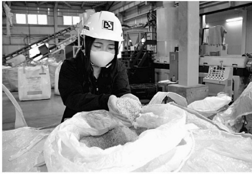
廃プラスチックを再生したペレット。製造には強みの破砕技術を活用した＝掛川市のプラントシステム掛川工場
