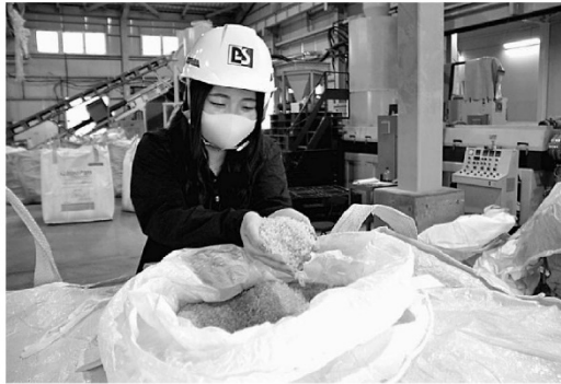
廃プラスチックを再生したペレット。製造には強みの破砕技術を活用した＝掛川市のプラントシステム掛川工場
