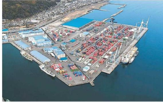
国土交通省は2021年度、清水港新興津埠頭（ふとぎ）の岸壁延伸工事に着手する。大型のバルブ船・コンテナ船を複数停泊させ、積み降ろしや倉庫への出入庫作業も非効率さが目立っていた。国は新規事業として、岸壁の西端を200メートル延長し、水深も大型船舶の停泊地にふさわしい15メートルを確保する工事を計画した。21年度に着手し、5年間に投じる総事業費として78億円を見込む。
