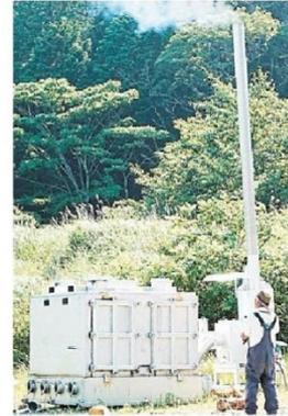
二酸化炭素削減のために新たに開発された移動式炭化ユニット
