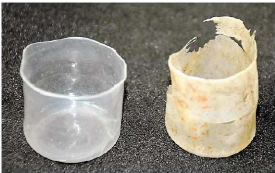
海底に設置し微生物の働きで自然に分解した、新型の生分解性プラスチック製のコップ。海底に沈める前(左)と約半年後に引き揚げたもの(右)。
